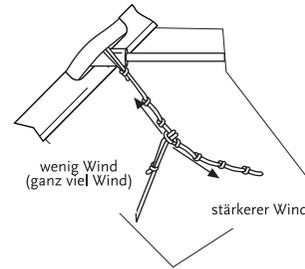
TIP: Bei viel Wind wird der MAESTRO kräftig ziehen. Um das Material zu schonen stellen Sie die Waage nun wieder flacher und/oder setzen Sie das Bremssegel ein.
